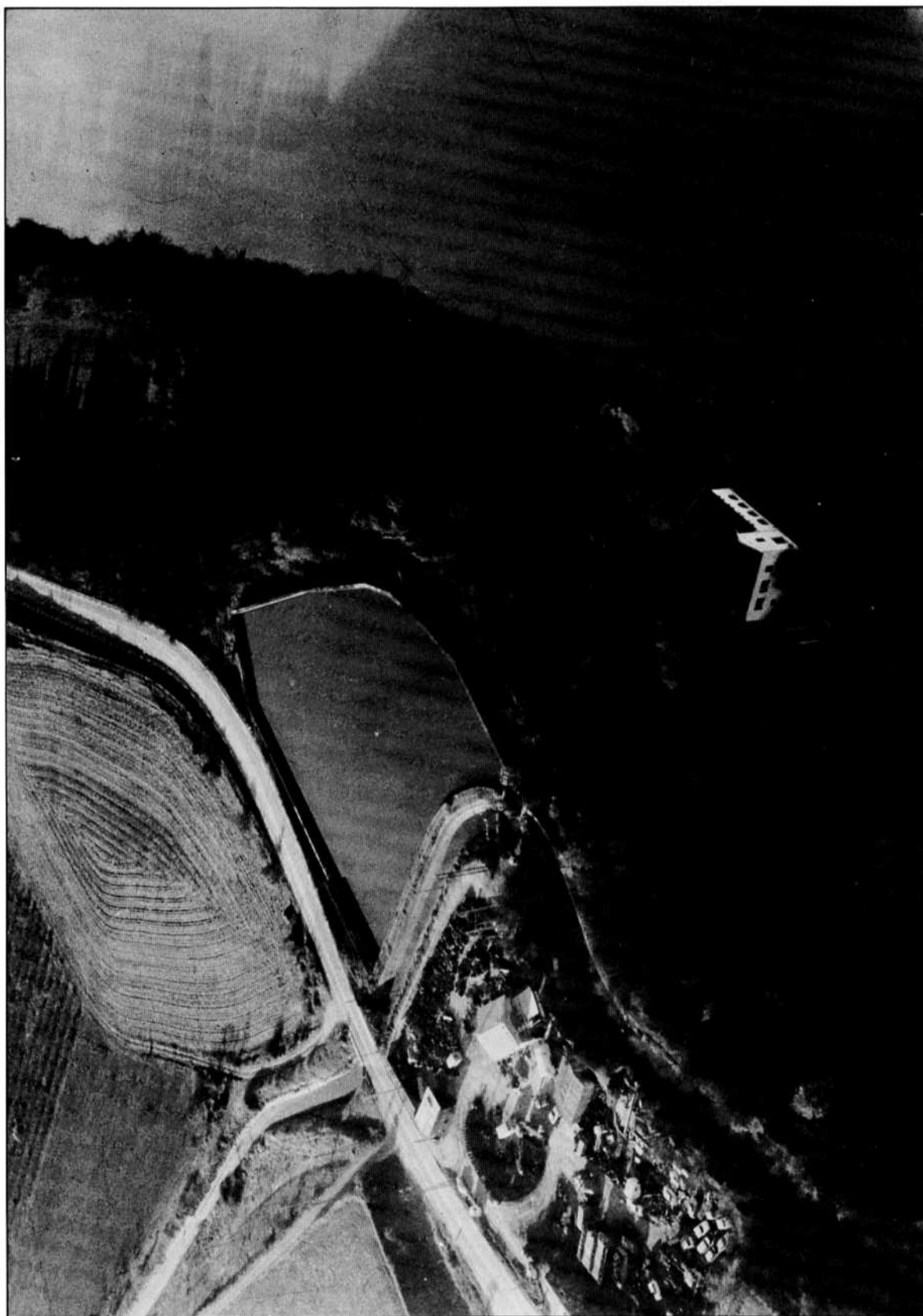
N° 2 A l'Écancière, le canal vient du Nord-Est (à gauche en bas), il tourne au Sud vers la plaine iséro-rhodanienne, passe sous la N 538. Il emplit le réservoir d'où sort une conduite raide (chute de 35 m) sur la petite usine hydro-électrique (invisible de la route). Les eaux turbinées rejoignent l'Isère. 11 millions de KWH vendus à l'E.D.F.
